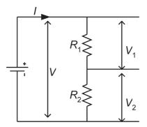
Gambar 5.8 Rangkaian seri untuk membagi tegangan
