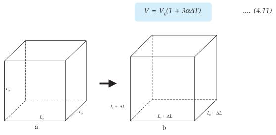
**Gambar 4.5.** Pemuaian suatu benda berbentuk kubus dengan panjang sisinya  $L_o$ . a) sebelum dipanaskan dan b) sesudah dipanaskan .
