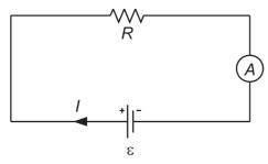
Gambar 5.16. Penggunaan amperemeter untuk mengukur arus listrik
