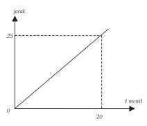
**Gambar 2.8** Jarak yang ditempuh sebagai fungsi waktu pada gerak lurus beraturan
