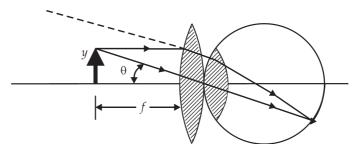
Gambar 3.7. Proses pembentukan bayangan oleh suatu lup dengan posisi benda berada pada titik fokus dari lensa lup tersebut.
