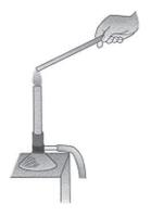
Gambar 4.6. Batang besi yang dipanaskan pada salah satu ujungnya.
