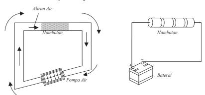
Gambar 5.1 Analogi antara aliran air dan listrik
