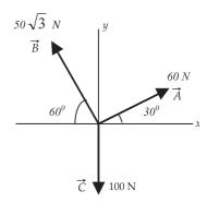
10. Empat buah vektor seperti pada gambar di bawah ini, 1 skala = 2 N.
