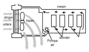
Gambar 4.9. Pendinginan mesin mobil untuk menggambarkan perpindahan kalor secara konveksi paksa.
