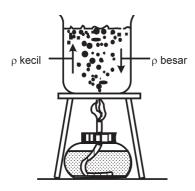
Gambar 4.8. Pemanasan air untuk menggambarkan perpindahan kalor secara konveksi.
