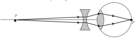
**Gambar 3.6.** Proses pembentukan bayangan di retina pada orang yang menderita rabun dekat setelah memakai lensa negatif
