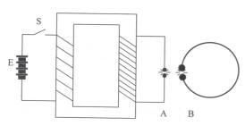
**Gambar 6.3** Kumparan Ruhmkorf untuk membangkitkan dan mendeteksi gelombang elektromagnetik (Bob Foster, 2003)
