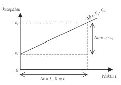
Gambar 2.9 Gerak lurus berubah beraturan
