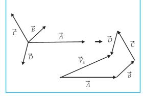
**Gambar 1.5.** Penjumlahan empat buah vektor  $\overrightarrow{A}$ ,  $\overrightarrow{B}$ ,  $\overrightarrow{C}$  dan  $\overrightarrow{D}$  secara grafis (metode poligon)  $\overrightarrow{V}_R = \overrightarrow{A} + \overrightarrow{B} + \overrightarrow{C} + \overrightarrow{D}$
