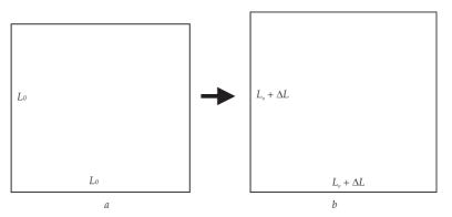
**Gambar 4.4** Pemuaian suatu benda tipis berbentuk bujur sangkar dengan sisisinya  $L_a$  a) sebelum dipanaskan dan b) sesudah dipanaskan
