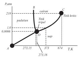
**Gambar 4.1** Diagram fase untuk air. Skala tekanan dan suhu tidak linier (Tipler, 1991)
