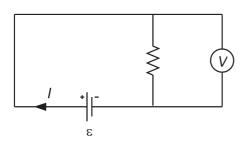
**Gambar 5.18.** Penggunaan voltmeter untuk mengukur beda potensial listrik
