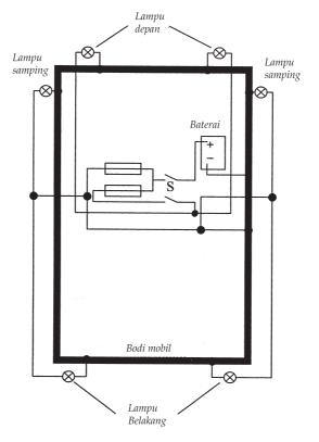
Gambar 5.12 Sistem aliran listrik pada sebuah mobil
