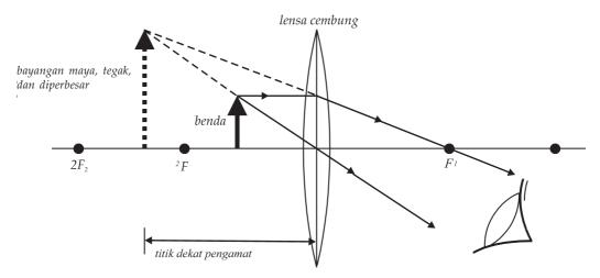
Gambar 3.4 Proses pembentukan bayangan pada lup dengan mata berakomodasi paling kuat.
