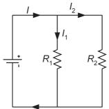
Gambar 5.9. Rangkaian paralel untuk membagi aliran arus listrik
