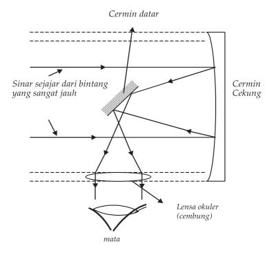
Gambar 3. 17. Diagram sinar teleskop pantul untuk pengamatan benda langit
