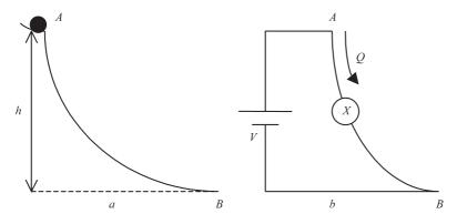
Gambar 5.13. Kemiripan antara bola yang meluncur dengan aliran muatan positif
