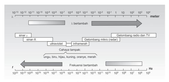
Gambar 6.4 Spektrum gelombang elektromagnetik (Bob Foster, 2003)
