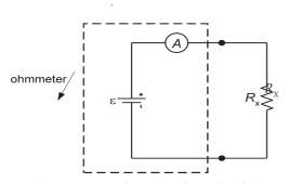
Gambar 5.20. Pengukuran hambatan listrik dengan menggunakan sebuah amperemeter
