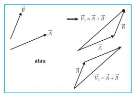
**Gambar 1.4.** Penjumlahan dua buah vektor  $\overrightarrow{A}$  dan  $\overrightarrow{B}$  dengan metode grafis (poligon)
