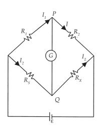
Gambar 5.21. Metode Jembatan untuk mengukur besar suatu hambatan
