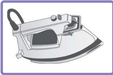
Gb. 5.6 Setrika listrik terbuat dari campuran bahan konduktor dan isolator
