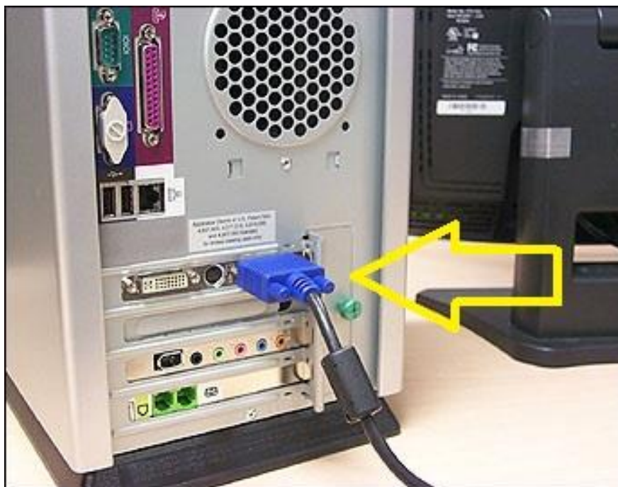
Gambar contoh pemasangan kabel vga ke cpu.
