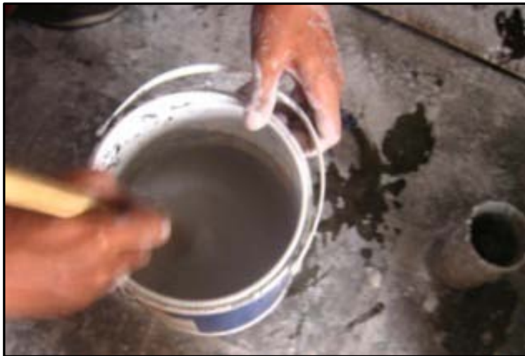
Gambar 104. Membuat Adonan Fiberglass Sumber: Dokumentasi pribadi
