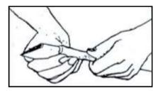
Gambar 3-14. Cara mengasah dengan batu lengkung Sumber : Foto Dok pribadi
