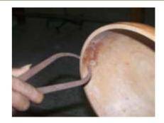
Gambar 4-12. Mengkur ketebalan benda kerja. Sumber : Foto Dok, Pribadi.
